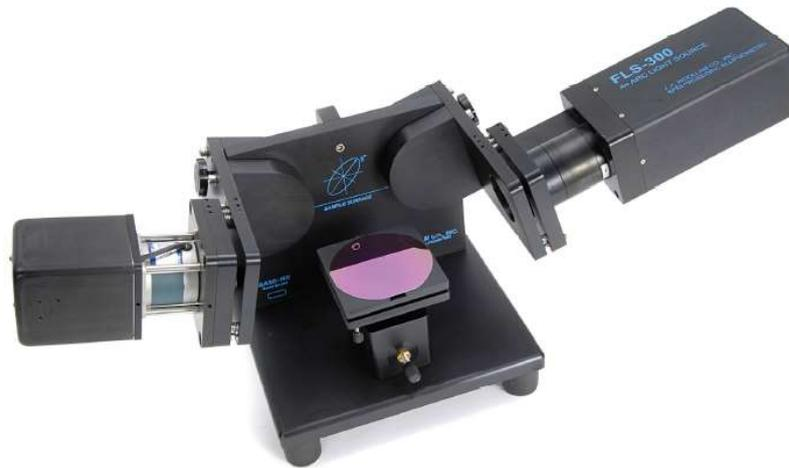
**Figura 1. Montaje experimental de la base del elipsómetro M2000X, en la configuración de ángulo fijo de 75°, con fuente de luz de Xenón de 75 W [4]**
