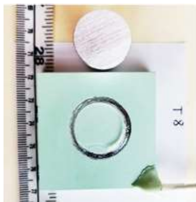
Figura 7. Fotografía luego del ensayo Pull-off del sistema compuesto por TEA.
