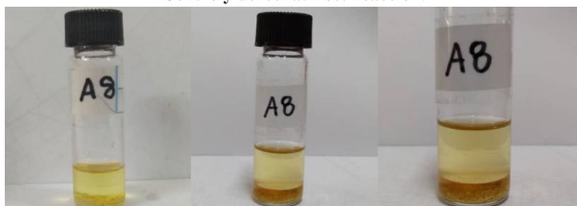
**Figura 9.** Transesterificación utilizando arcilla STx-1b impregnada con KOH. Izquierda: Pre-reacción. Centro y derecha: Post-reacción.
