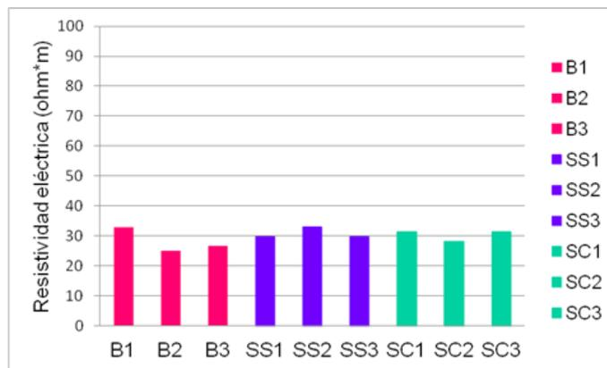
Figura 1. Resistividad eléctrica a los 28 días de curado.
