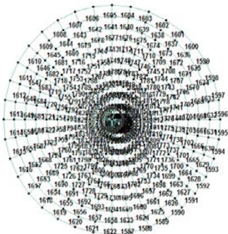
Figura 13. Numeración de los plates de la cúpula del tanque
